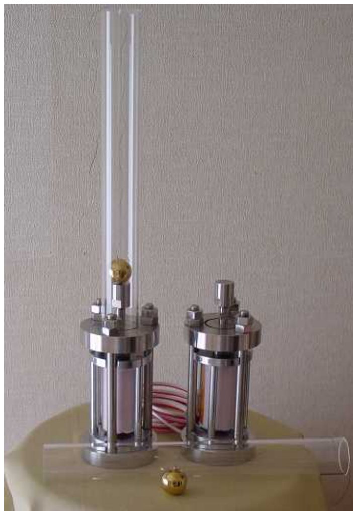
図1 逆磁歪式振動発電機の外観写真 付属品:落下筒と黄銅球(72g)
