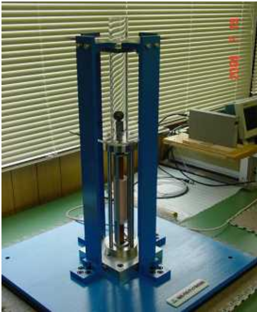
図1. SMT製逆磁歪式振動発電機 黄銅球を落下衝突させて発電
